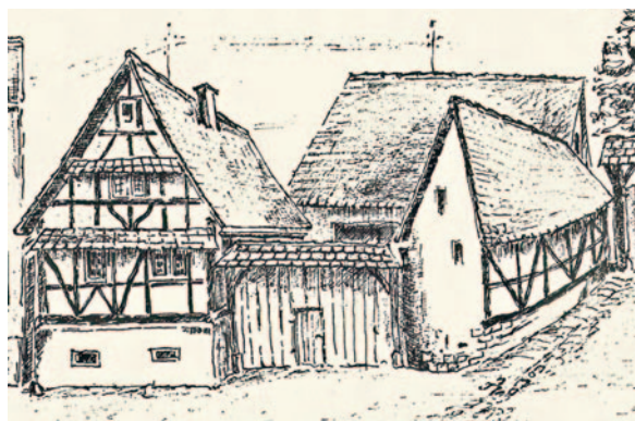
So sieht das Anwesen unter dem Fassadenputz aus – mit gebogenen Fußstreben und bauzeittypischen, geschosshohen Streben. Auch Wetterdächer waren zum Schutz des Fachwerks angebracht.
